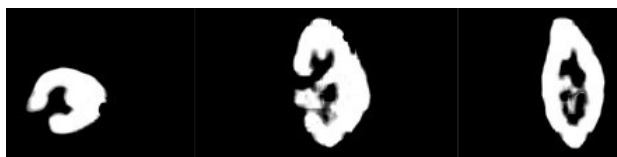
Figura 3: Imagem de Tomografia Computadorizada do phantom preenchido com EcoFlex 0020 (HU médio = 227)
