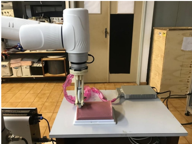
Figura 1: Aparato experimental completo, contendo o braço robótico, o transdutor e phantom .
