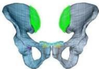
Figura 3: Pelve com suas condições de contorno, propriedades dos materiais definidas e malhas no programa SimLAB™.
